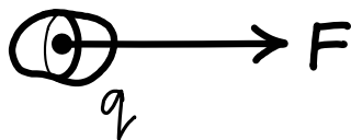
Фигура 1: Електромагнитна сила действаща на пробен заряд
