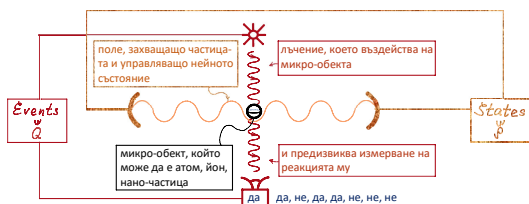
фиг. 19: Схема на квантова система: включени са наблюдавания микро-обект и измервателната установка
