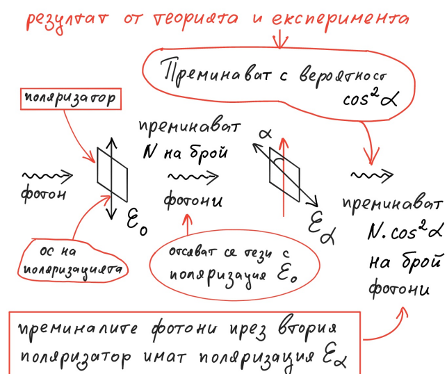
фиг. 4: Статистика на преминалите фотони през поляризатор след първоначална селекция
